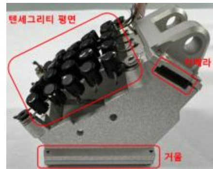
그림 1. 텐세그리티 시촉각 센서
