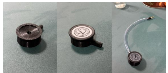
그림 1. 좌, 청진 헤드 중앙, 다이어프램을 붙인 청진헤드 우, 조립 완성된 간이 청진기
