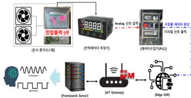
Fig. 3. Design of livestock domain data collection system 그림 3. 축사도메인 데이터 수집시스템 설계
