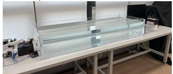
그림 2: 자동 링크 정렬을 지원하는 수중 무선 광 통신 시스템의 전체 구성도
