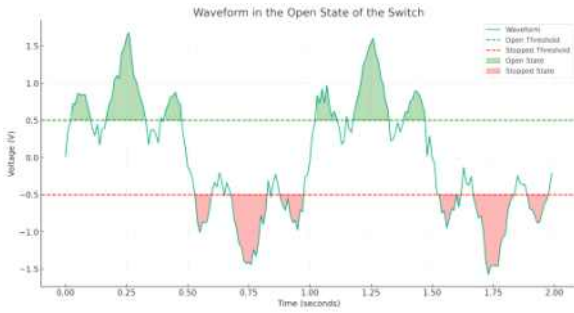
그림 2 전원공급 파형 테스트를 통한 개폐기 동작 임계점 파악 fig2. Identify switchgear operation thresholds with power supply waveform testing
