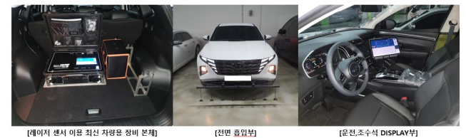
[그림 4] 최신 차량장착형 검사장비의 전체 시스템
