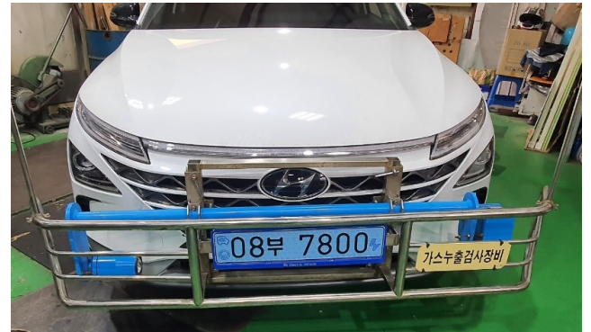
[그림 3] Optical Methane Detector의 전면부
